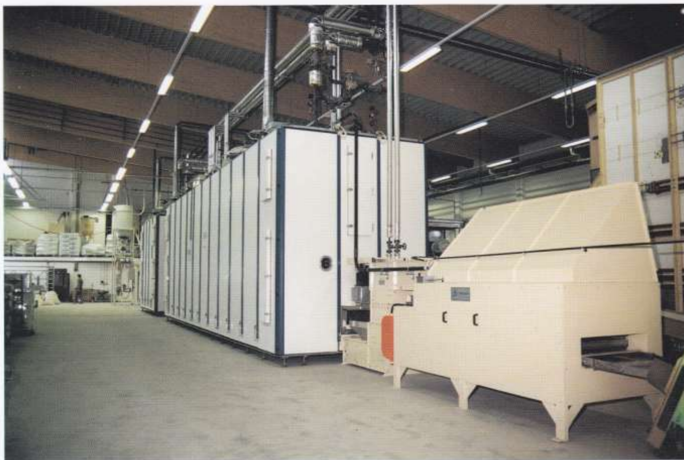
Nastro in tessuto poliestere inserito in essiccatoio per pasta alimentare
