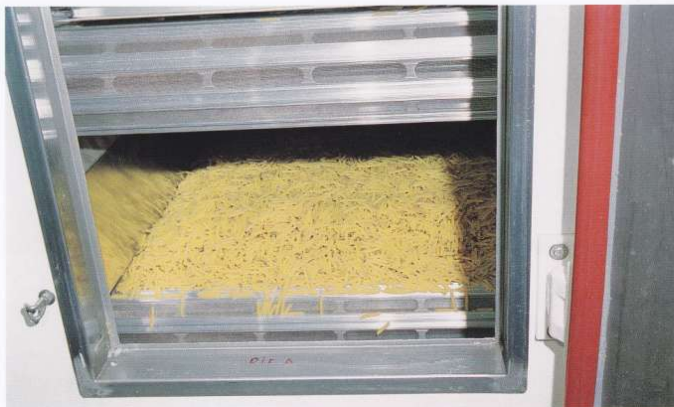
Particolare di nastro in tessuto poliestere inserito in essiccatoio per pasta alimentare
